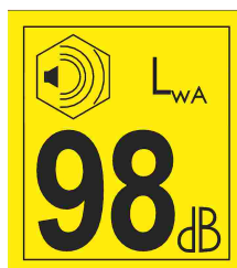
Obr. 11: Bezpečnostní piktogram – garantovaná hladina hluku
