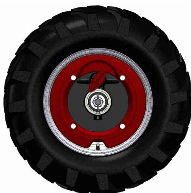
Obr. 27: Polohy ovládacích páček palce volnoběžného náboje kola (zobrazeno je levé kolo, pravé zrcadlový obraz)
