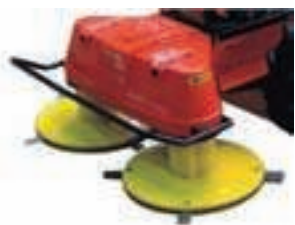
Čtyřnožové žací bubny s protibežným smyslem otáčení
