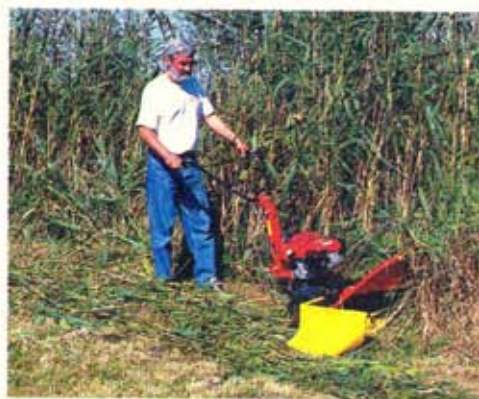
Sestava: převodová skříň DSK 316 se zpátečkou, motor HONDA, jednobubnové sečení SAMSON si poradí i s rákosím, plevelem a stařinou.
