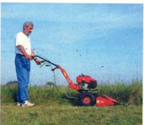
Sestava: převodová skříň DSK 316 se zpátečkou, motor HONDA, prstové sečení, vhodné k sečení vojtek a jelek, šíře 100 cm.
