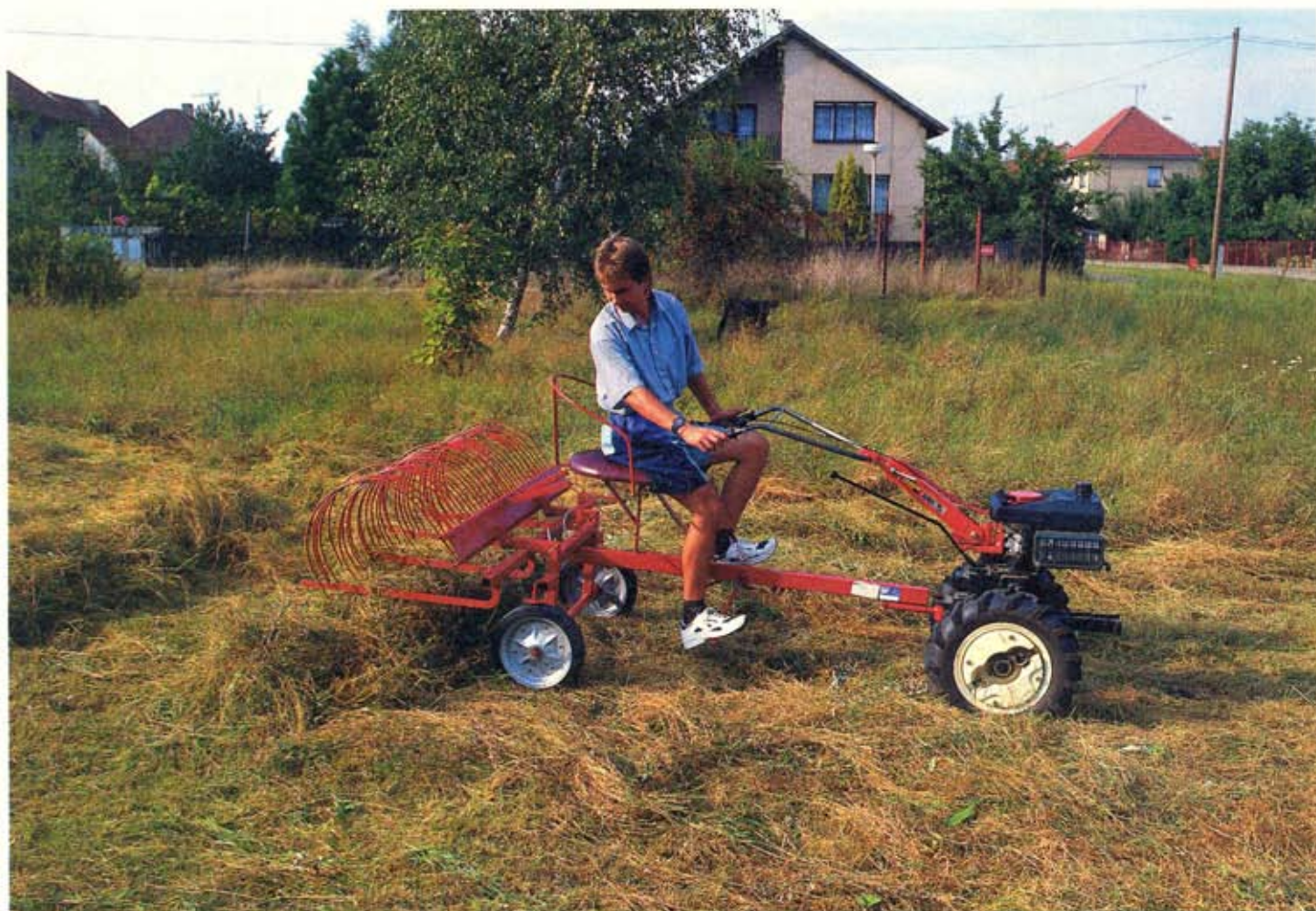
K úklidu posečené trávy slouží shrabovač ve spojení s malotraktory VARI.
