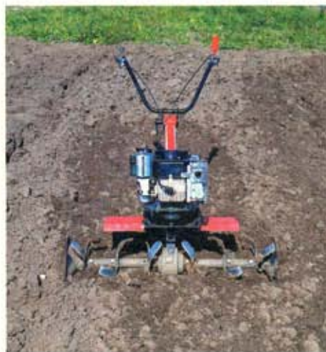
Výměnou kol za okopávací nože získáme rotavátor
