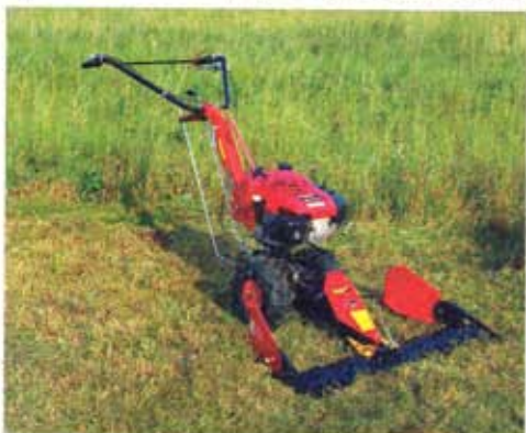
Sestava: převodová skříň DSK 316 se zpátečkou, motor HONDA, bezprstá lišta šíře 100 cm, k sečení udržovaných luk.
