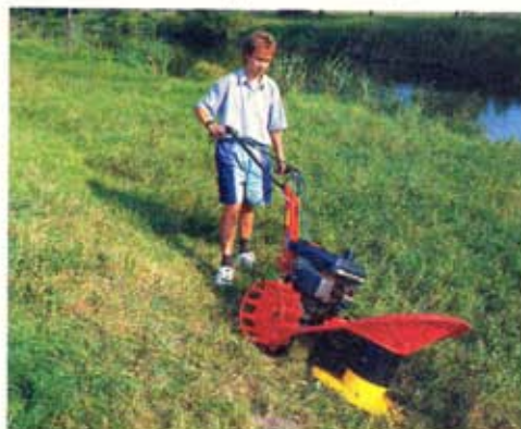
Sestava: převodová skříň DSK 316, motor 2-takt VARI HORAL 5,5 HP, jednobubnové sečení SAMSON, přidavná svahová kola pro příkopy, nebo horské svahy.
