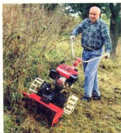
Mulčovač ve spojení s DSK 316, dokonale rozeeme zaplevelenou stařinu. Na obrázku s přidavnými svahovými koly.
