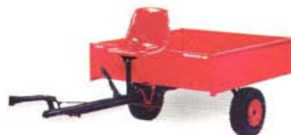
Vyklápěcí návěs Nosnost: od 220 do 355 kg
