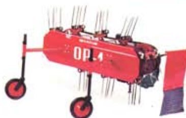
Shrnovač a obraceč píce Záběr: 100–120 cm
