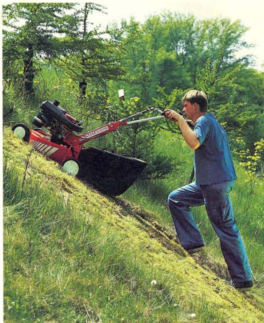
**Motorové sekačky LTS patří do stavebnicového systému VARI. Připojují se k nim veškeré typy motorů VARI systému, které mají dvojnásobný výkon než u běžných sekaček. 2-taktní motory mají 4 800 otáček a jako jediné na našem trhu jsou vhodné na sečení přerostlé trávy a zejména na sečení prudkých svahů.**
