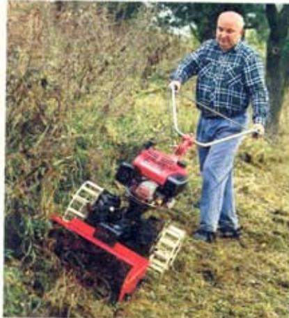
Mulčovač ve spojení s DSK 316, dokonale rozemle zaplevelenou stařinu. Na obrázku s přídavnými svahovými koly.
