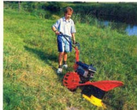
Sestava: převodová skříň DSK 316, motor 2-takt VARI HORAL 5,5 HP, jednobubnové sečení SAMSON, přídavná svahová kola pro příkopy, nebo horské svahy.
