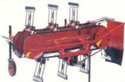
Pásový obraceč a shrnovač
