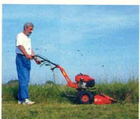
Sestava: převodová skříň DSK 316 se zpátečkou, motor HONDA, prstové sečení, vhodné k sečení vojtěšky a jetele, šíře 100 cm.
