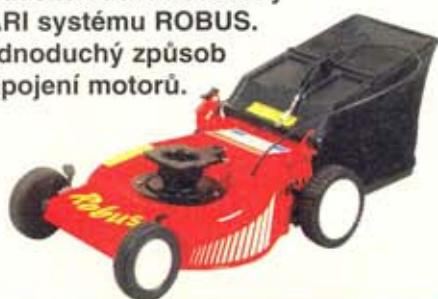
Žací ústrojí s pojedzdem. Sekací nůž je spojen s motorem přes spojku, čímž je zamezeno poškození motoru.
