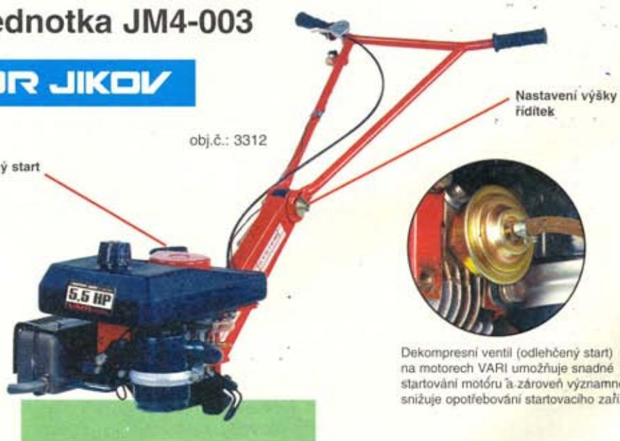
Dekomprezni ventil (odlehčený start) na motorech VARI umožňuje snadné startování motoru a zároveň významně snižuje opotřebování startovacího zařízení.
