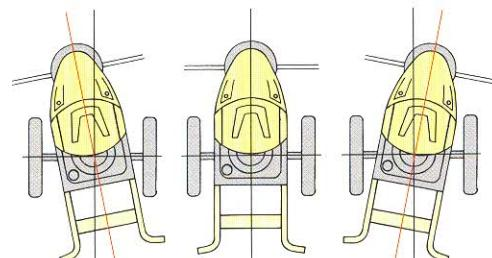
Možnost vyklápění do stran pomocí odjištění fixační páčky pro sečení podél zdí.
