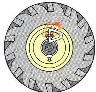
Po výměně nožů na kola umožňuje jejich třípolohová uzávěrka kol snadnou manipulaci se strojem vypínáním a zapínáním volnoběžky kol.
