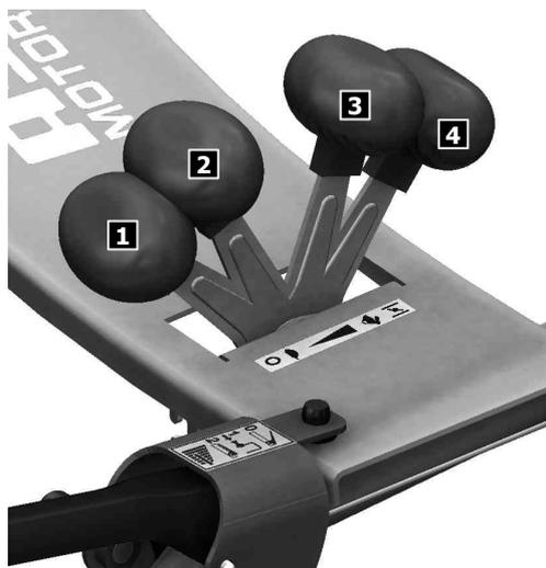
Abb. 4: Positionen des Hebels des Beschleunigers
