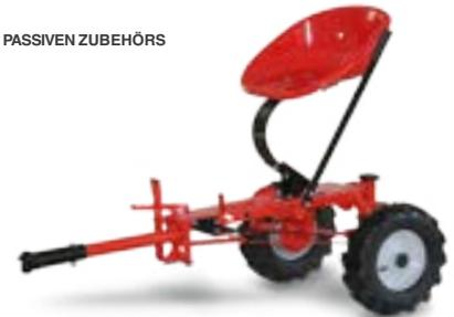
Nutzlast 250 kg, abgefederter Sitz, Betriebsbremse
