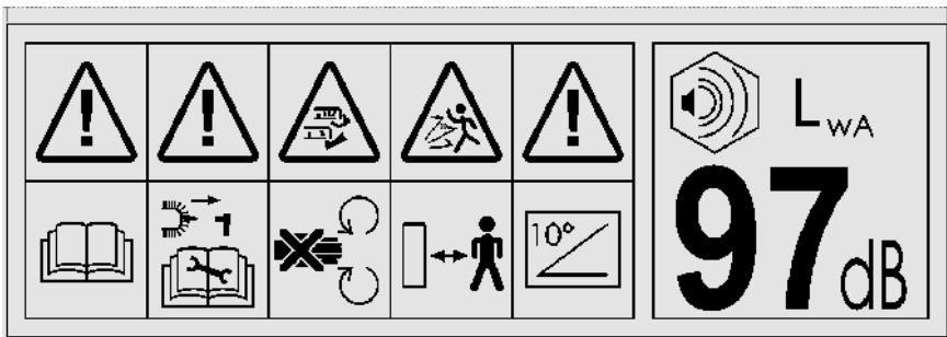
Obr. 15: Bezpečnostní pikrogram – sdružená samolepka
