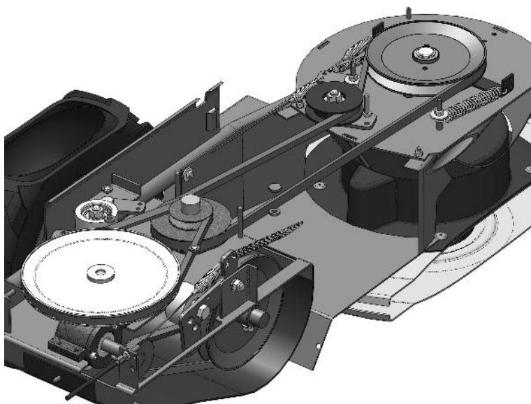
Obr. 12: Trasa klínového řemene
