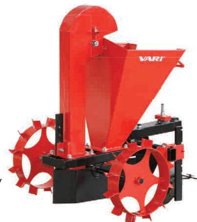
Sazeč brambor SB-40 vpředu nesený automatický jednořádkový sazeč s miskovým mechanismem a zásobníkem pro 20 kg sadby rozchod 61 cm obj. číslo: 4363 CENA (Kč s DPH): 9 490 Kč
