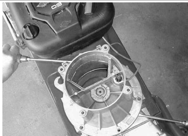
Obr. 2: Vypáčení skříně nože
